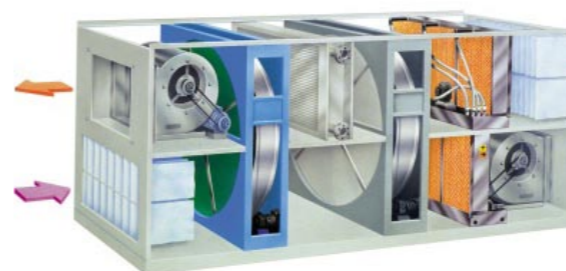
DesiCool är ett klimatsystem från Munters som gör värme till kyla genom att använda sorptiv kylteknik för att producera sval luft som distribueras genom byggnadernas tilluftskanaler. DesiCool kyls luften i två steg: först genom kylning i en roterande värmväxlare och slutligen i en evaporativ kylare.
